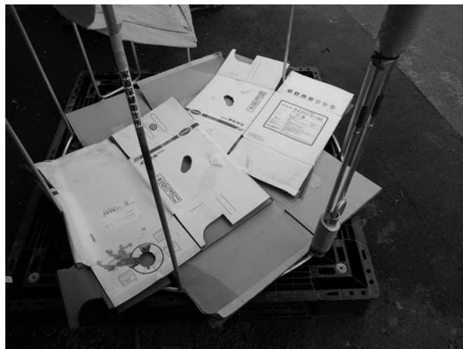
図 12 パレット底部の破損対策
