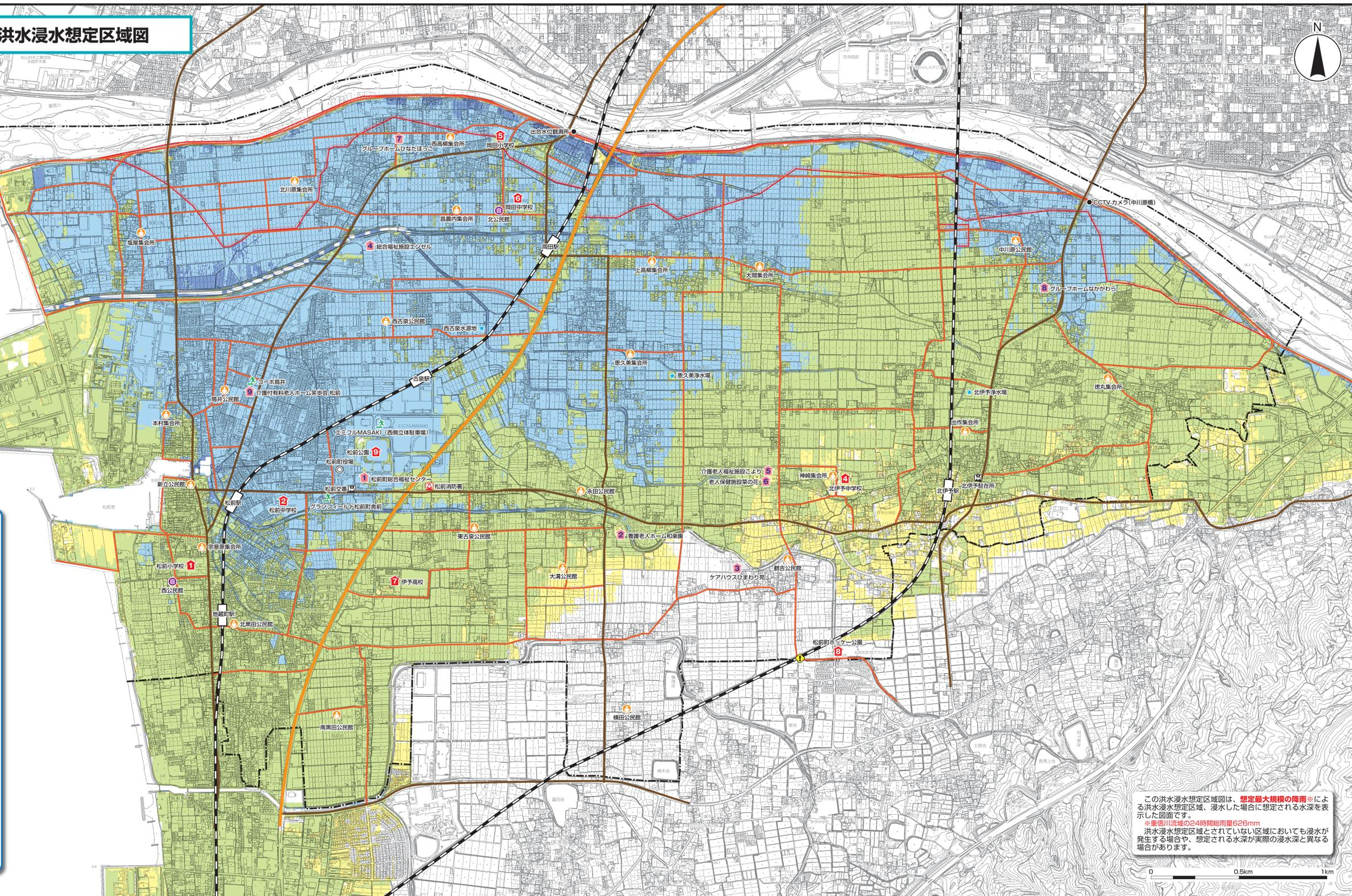
この洪水浸水想定区域図は、**想定最大規模の降雨**※による洪水浸水想定区域、浸水した場合に想定される水深を表示した図面です。
