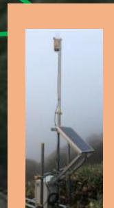
下水道の水位測定
