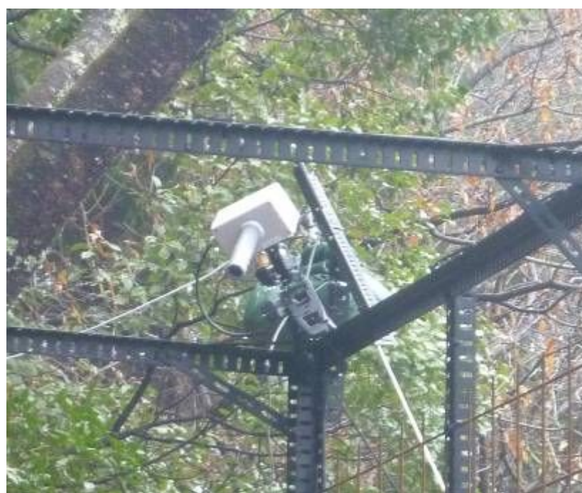
図 13 赤外線感知装置（上図：全体図・下図：設置時）
