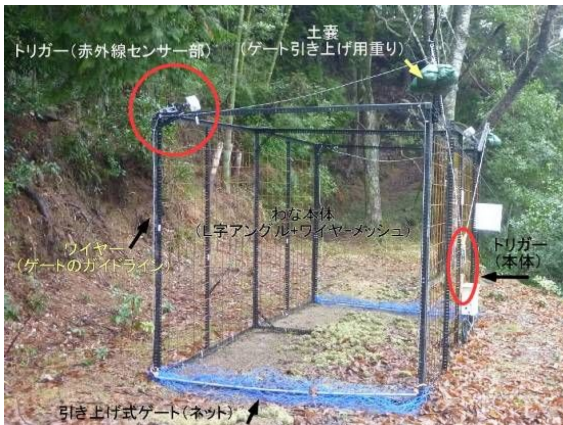
図1 四国連携事業 中型囲いわな（引き上げゲート式・赤外線トリガー型）
