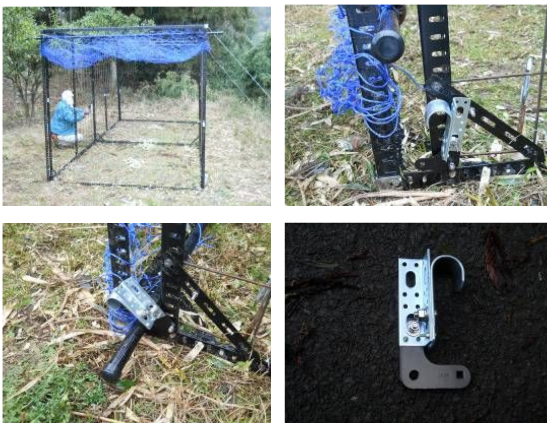
図 12 落下ゲート式のロック機構
