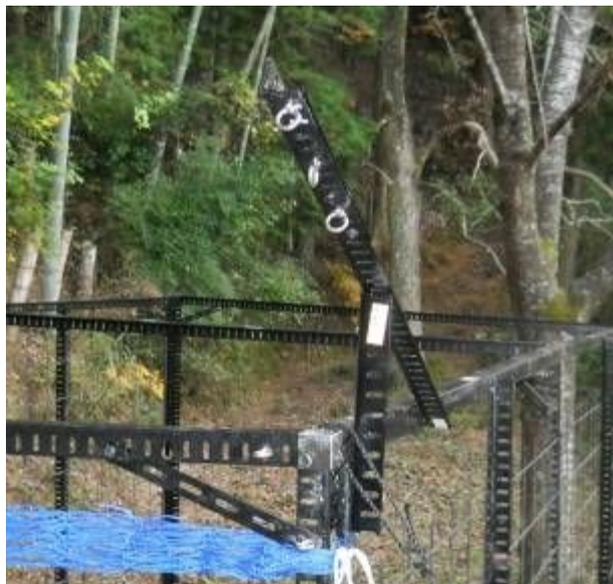
10) 引き上げ棒のロープにつけたナス環(スナップフック)とワイヤーを介して土嚢(重量 5~7kg)を吊り下げる。
