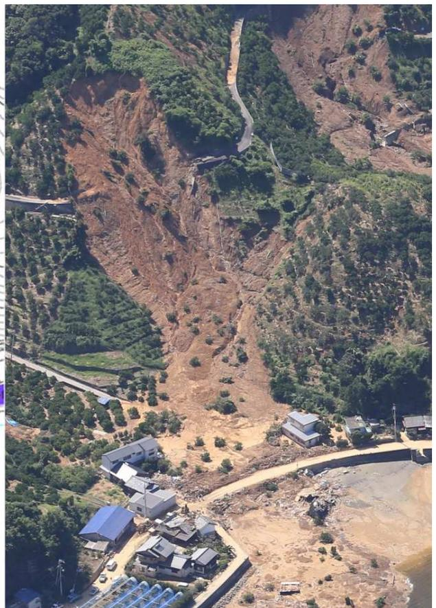
図一 2.22 O次谷（緩い集水型斜面）で発生した土石流の事例（宇和島市吉田町白浦）
