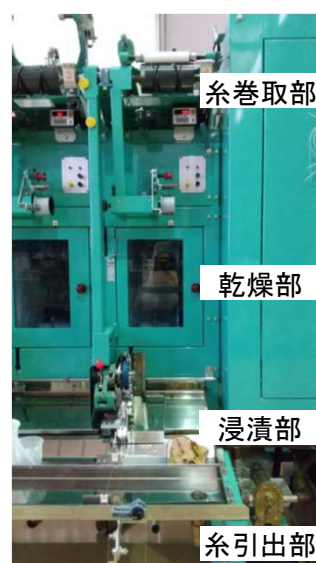
＜糸へのCNF付与装置＞ サイジングワインダー
