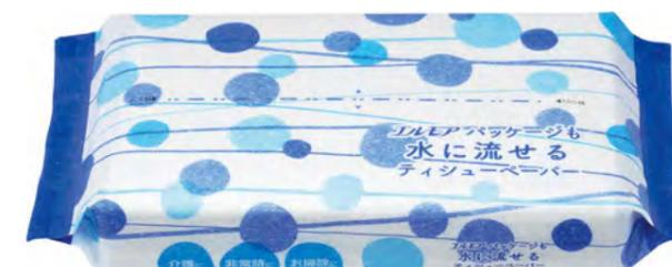
木材パルプとバイオマスプラスチックであるポリ乳酸を混合した紙で、廃棄しても自然分解されます。また、使用しているプラスチック繊維は熱可塑性樹脂なので、ヒートシールが可能です。繊維の混抄具合で、物性が替わり、用途に応じて調整ができます。プラスチック繊維を溶融させていない水解紙だけでなく、溶融させた耐水紙も生産可能です。包装資材や、土中に残せる農業用資材などの使い方が期待できます。
