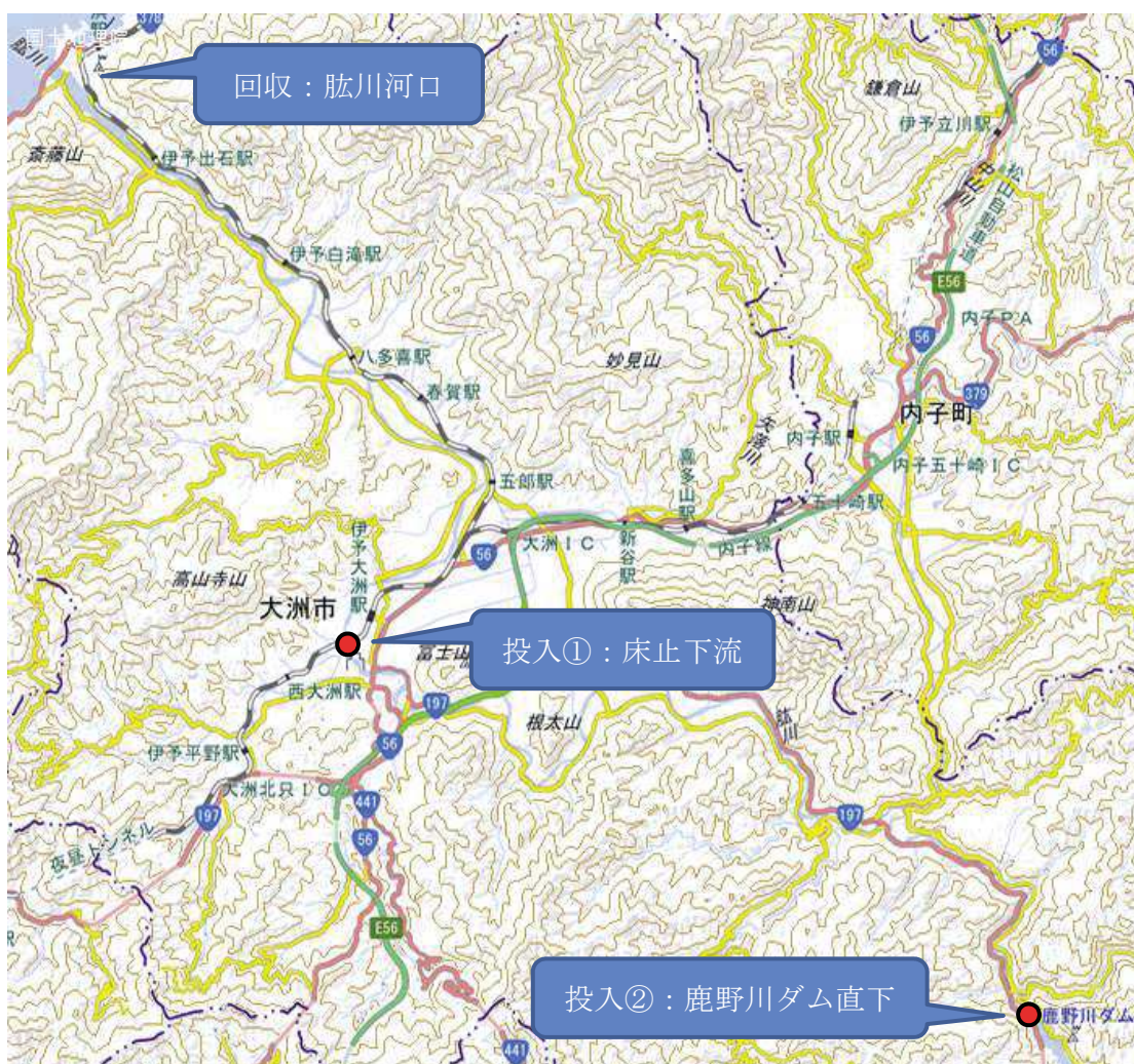
図 2-3-5 模擬プラスチックごみ投入場所及び回収場所
