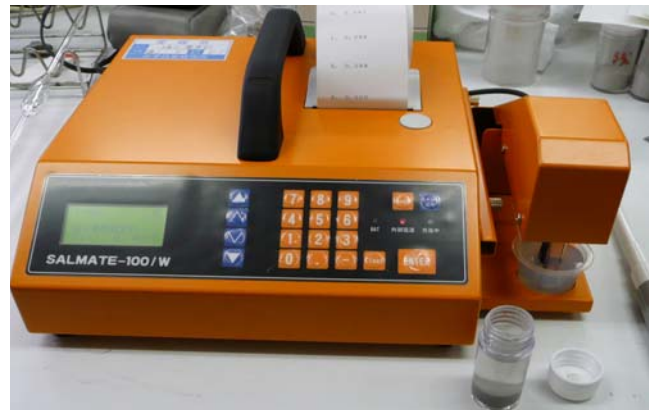
図2 使用する塩化物イオン分析機器 (電量滴定方式塩分計)
