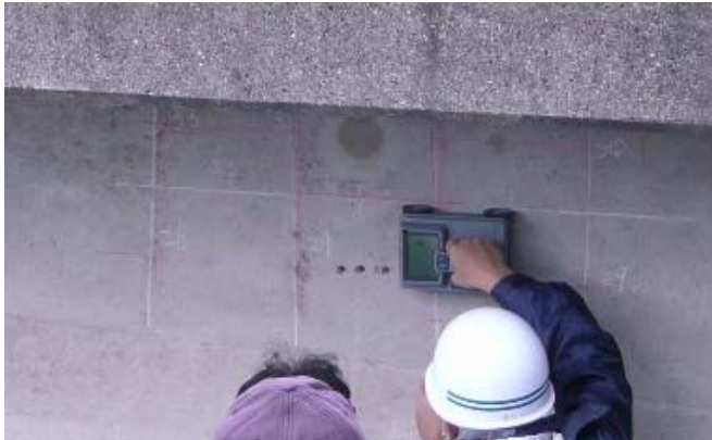
図3 鉄筋位置調査状況
