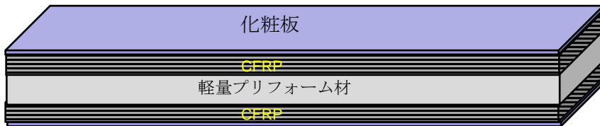
図1 軽量積層複合板の構成
