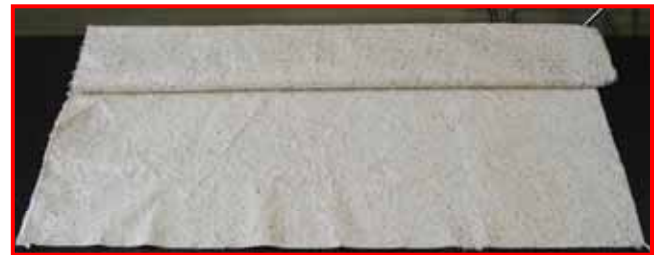
開発した農業用マルチシート (薄状化、強度向上に成功)
