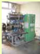
高温高压殺菌装置によるレトルト処理
