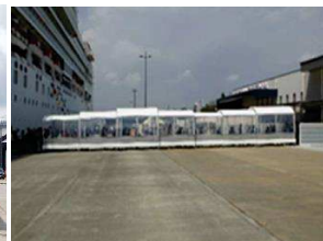
伸縮式屋根付き通路 (出典：国土交通省HP)
