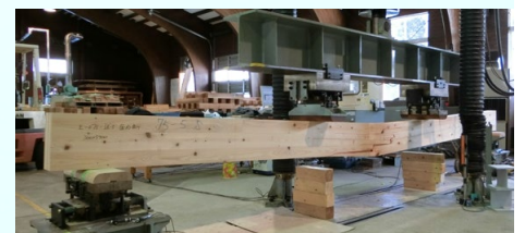
写真1 面内曲げ試験の状況
