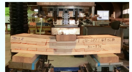
写真2 面外せん断試験の状況
