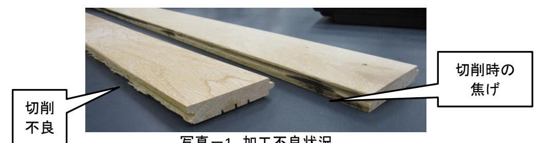
写真-1 加工不良状況
