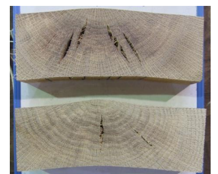
写真-3 人工乾燥後の内部割れ
