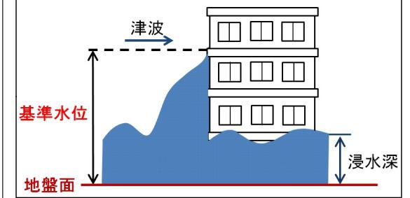
【地形(標高)データ】 〇 基準水位の算出に用いた「地形(標高)データ」は、平成25年度公表の津波 浸水想定図作成時に使用した地形である ため、その後の開発に伴う盛土や個別施 設の微細な土地の形状が現況と異なって いる場合があります。
