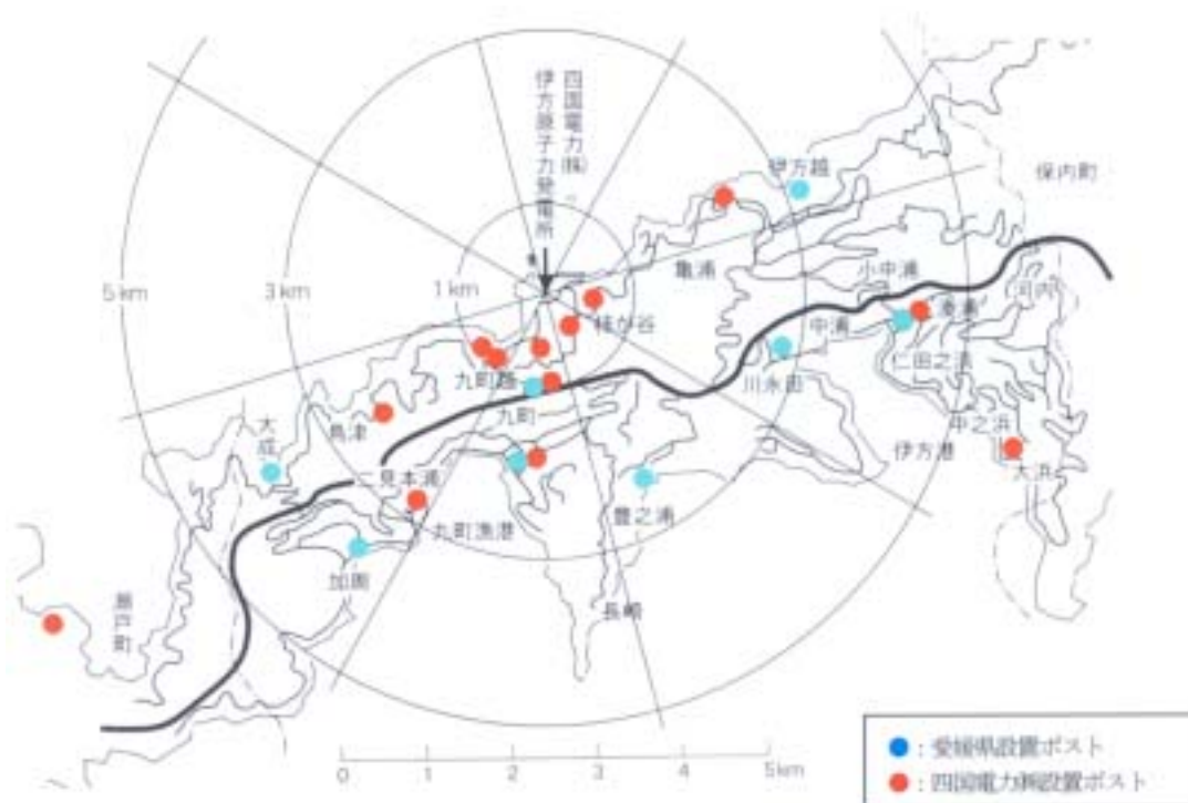
図2 - 7 - 5 固定モニタリングポスト設置地点
