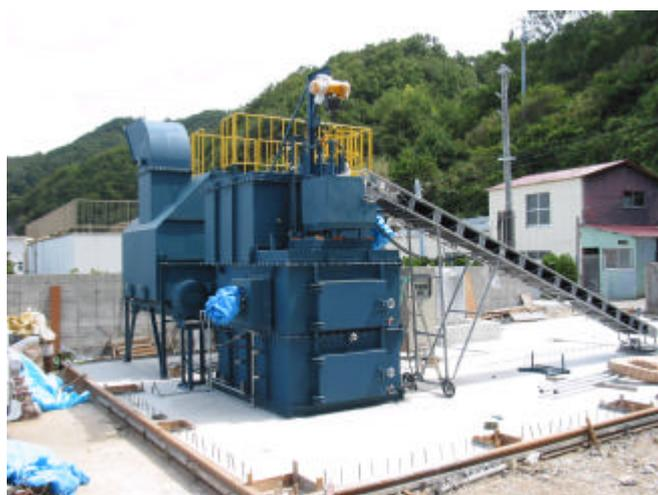
魚島村設置のえひめ方式焼却炉
