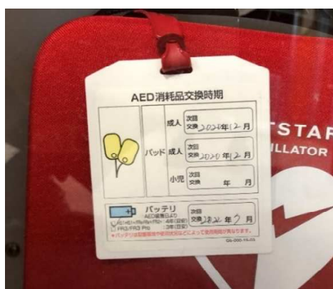
図 4 表示ラベルによる消耗品交換時期の表示
