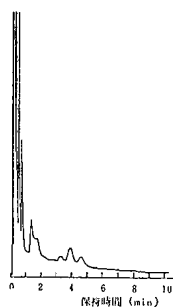
図6 試料(食品用ポリ塩化ビニル製品)のガスクロマトグラム
