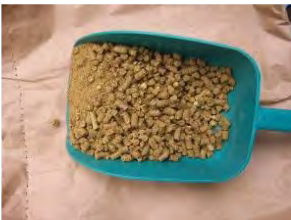
竹にトウフ粕と醤油粕を混合したペレット
