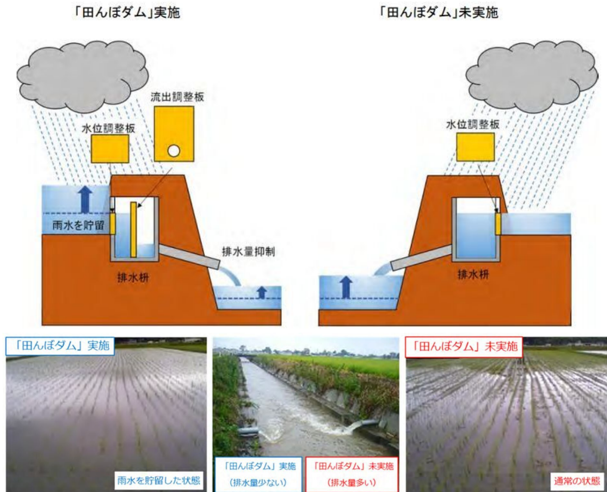
図 7.3. 水田貯留（田んぼダム）の設置イメージ （出典）田んぼダムの手引きより上図・写真を引用
