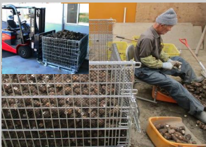
【鉄コンテナ利用による省力化】
