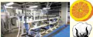
CNF連続脱水装置 (愛媛県・愛媛大学・県内製紙機械メーカーとの共同研究、特許出願中)
