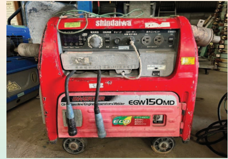
↑非常用電源の写真
