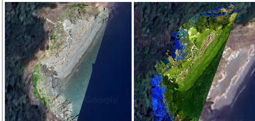
図3-6 8月調査時4a1のオルソ画像 (左:ドローン 右:マルチスペクトルカメラ)
