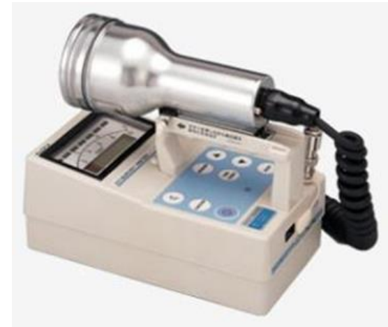
GM計数管式サーベイメータ (TGS-146型)
