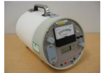
中性子用線量当量率 サーバイメータ
