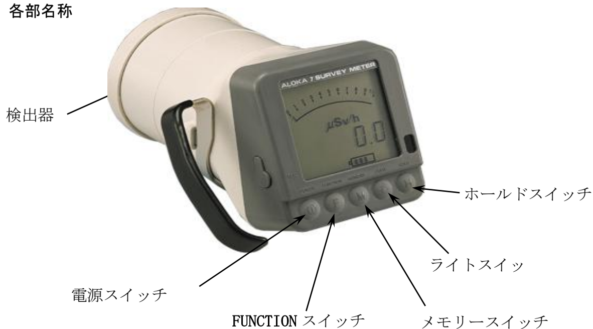
図 1-14 電離箱式サーベイメータ (ICS-323型)
