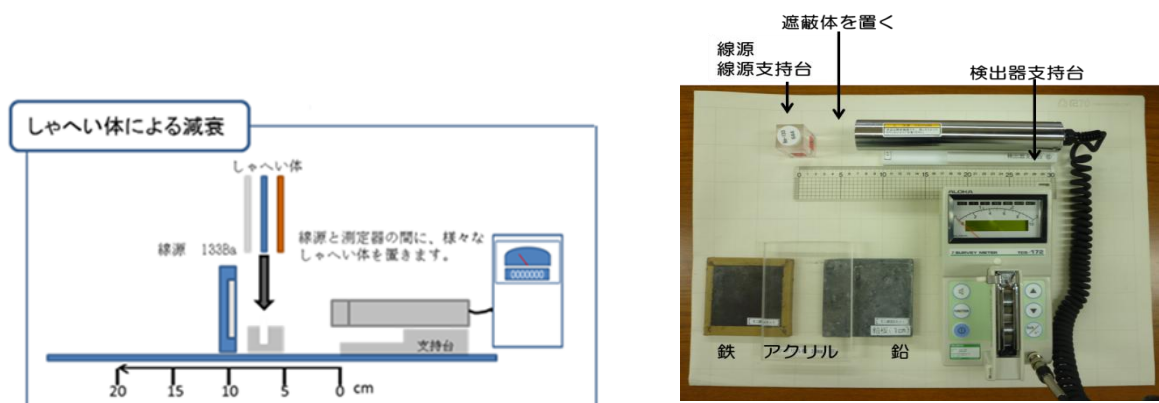
図1－6 \gamma 線に対する遮へい効果の測定方法
