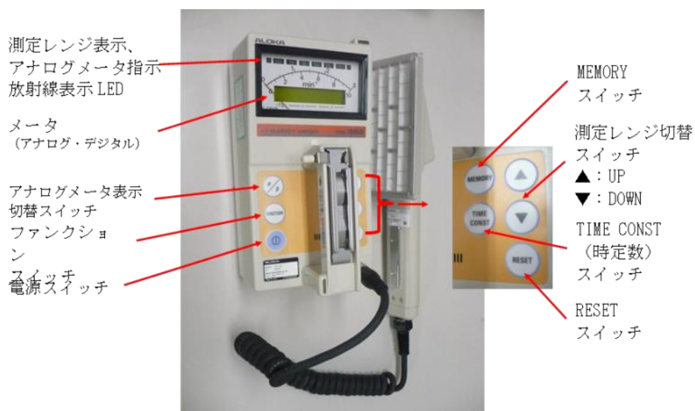
図 1 - 1 2 ZnS シンチレーション式サーベイメータ (TCS-362 型)
