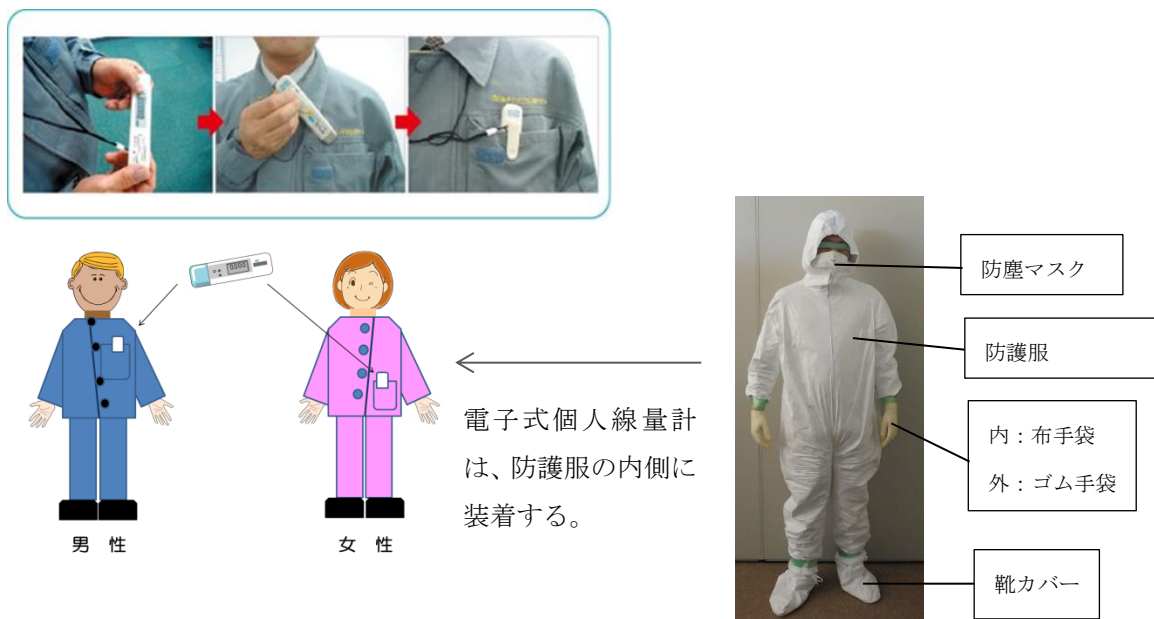
図 1 - 1 電子式個人線量計の装着
