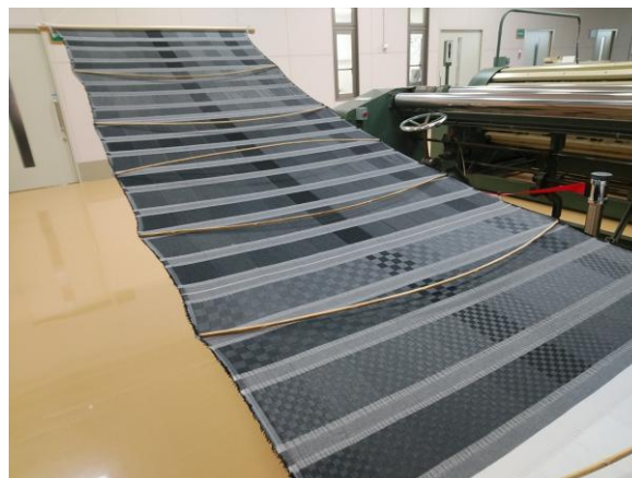
写真1 製織組織の組み合わせ試験結果
