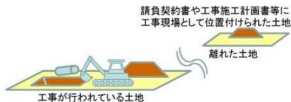
図1－1 「工事の現場」の考え方
