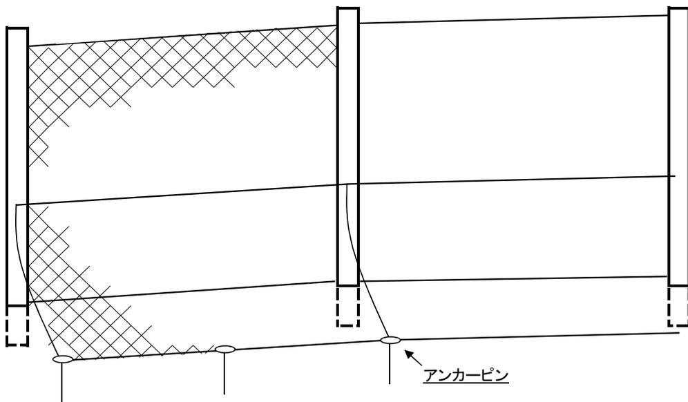
※スカートネットについても、地面の起伏に応じアンカーピンを打込み張設する。
