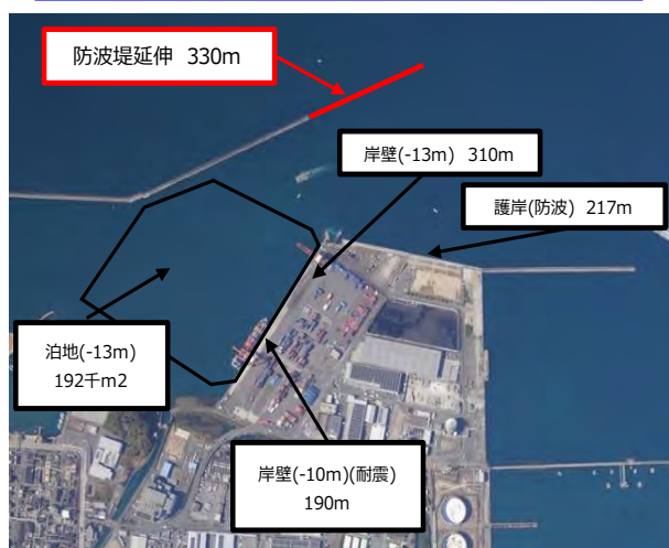
松山港（外港地区）国際物流ターミナル整備
