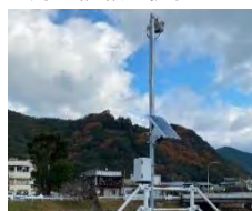
河川監視カメラ
