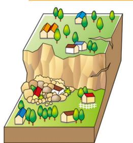
雨などの影響によって、土がゆるみ、急激に斜面が崩れ落ちます。ひとたび人家を襲うと逃げ遅れる人も多く死者の割合も高いです。
