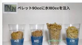
ペレット 90cc に水を 180cc 注入。試行錯誤の結果、他社製品と比べ吸水スピードが約 2 倍まで向上。
