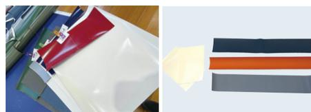
大きな面から裁断し、小さな端材は組み合わせて熱溶着し1枚の生地に。
