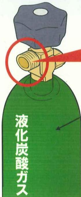
事故の背景には、酸素ボンベと同じ接続口（口径、ネジ部が同じ）の 工業用液化炭酸ガスボンベ を院内で採用していたことが確認されています。
