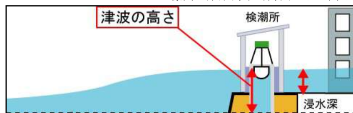
図 3-3-2 津波の高さの定義【気象庁】
