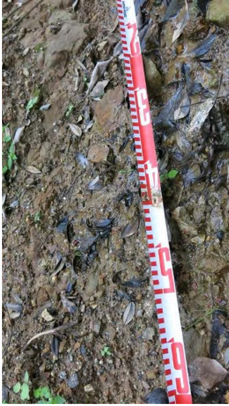
写真①不安定土砂（赤着色）：含水が高く粘性が高い堆積物。礫が浮いており基質はやわらかい。流木・土砂を多く含む。 上流部（上部）は厚さ 1m を超えるが、その他の箇所は厚さ 1m 未満が多い。
