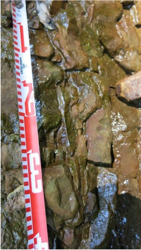
写真④砂岩：河床の侵食部に露出する砂岩。風化乏しく、上位の堆積物との境界は明瞭。
