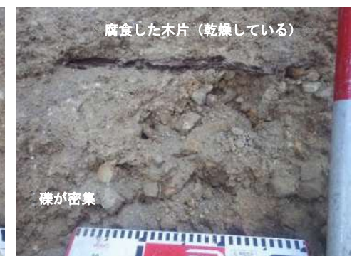
写真13 側方崖基部には局所的に風化礫が密集した領域が認められる。
