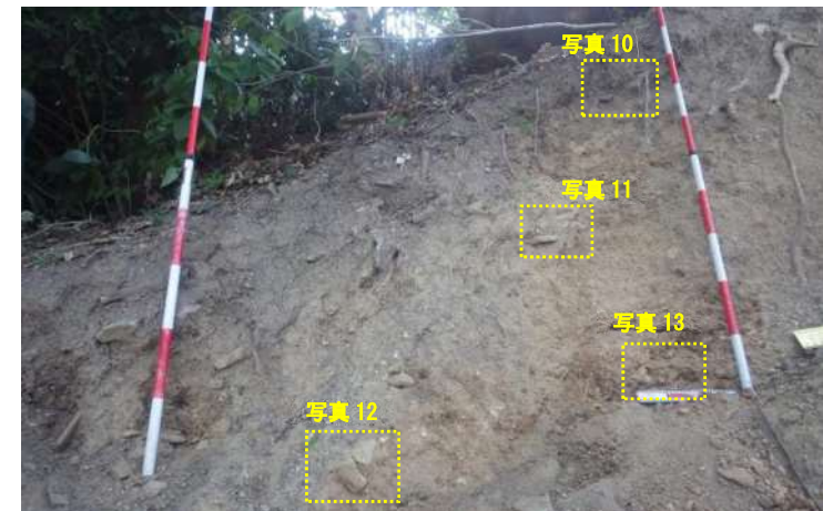
写真9 右岸側の側方崖（高さ1.5m程度）。ビニールや瓦片、花崗岩礫を含む。基質は全体に砂質で、細粒分は少ない。
