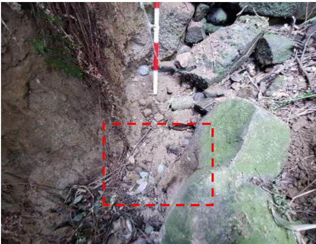
写真 3-4 旧池 (首あらい池) の出口付近 表面に僅かに溜り水が確認されるが流下していない (赤破線で囲った範囲は熱赤外線サーモカメラで測定)
