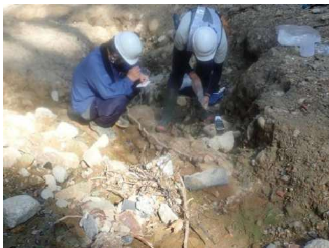
図 2-23 簡易水質測定状況 標高 60m 付近の湧水流下箇所 水温 29.1°C、電気伝導度 14.5mS/m、pH7.4 外気温 31.1°C
