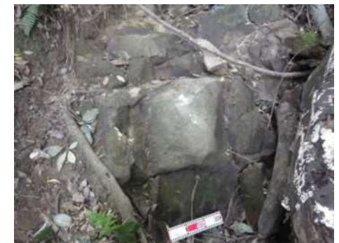
写真 1-2 ロープウェイ乗り場の西側の谷地形 D 中腹の旧池沿いに認められる砂岩 層理面は不明瞭。比較的新鮮・硬質。
