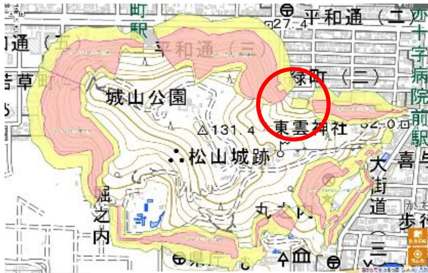
図1-5 土砂災害警戒区域等平面図
