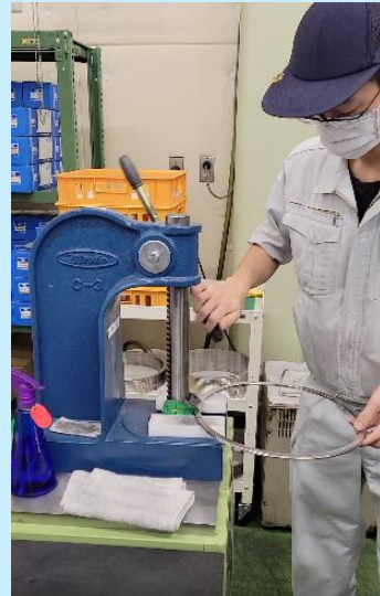
熟練工の加圧による歪みの修正
