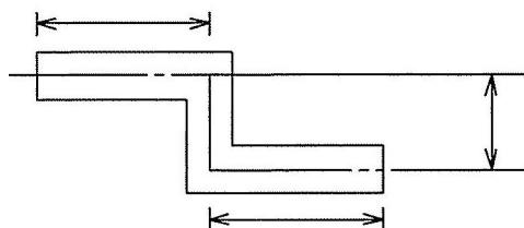
カ 配管配線は、原則として、図面上の平面部分と立上り、引下げ部分とに区分する。
