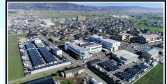
市庁舎（中央）の駐車場（庁舎左と下）に太陽光パネルを1,200枚設置。この発電した電力で庁舎の使用電力を自給自足しています。
