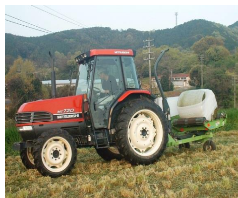
写真2 カビの発生を抑え、長期保存を可能とするためフィルムは6層巻とする。
