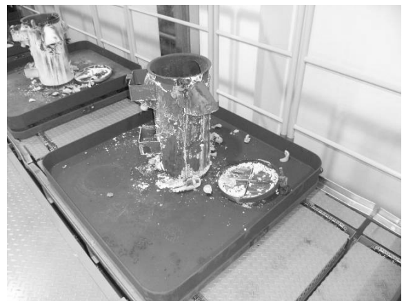
加熱分離炉で処理後の変圧器(トランス)
