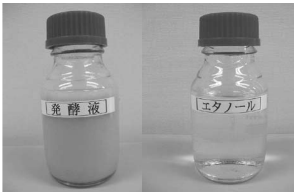
発酵液と蒸留して得られるバイオエタノール
