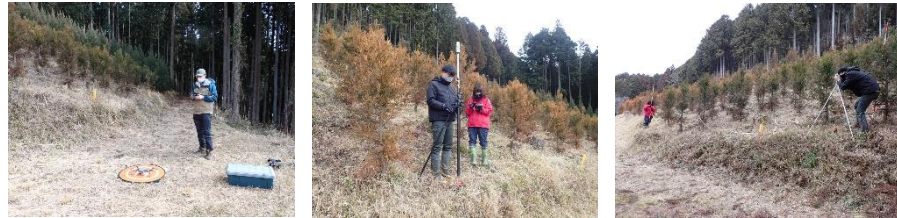
図-1 左からドローン写真測量、GNSS測量、コンパス測量
