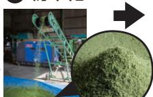
植織機で超微粒の竹粉末にする。1時間に1m<sup>3</sup>の粉末（孟宗竹約30本分）ができる。
