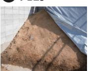
竹粉末（20m<sup>3</sup>分）を2~3ヶ月間発酵させる。温度・湿度を管理し、70℃で切り返して均一に発酵させる。
