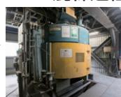
石炭灰・高炉セメント・消石灰を練り混ぜる。
