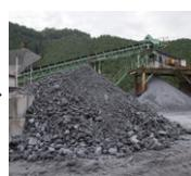
約1ヶ月仮置きし、溶出試験に合格したら後、出荷する。
