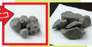
混練・固化した石炭灰に、自社採石場で採取した原石をブレンドし、一緒に破碎して約4cm以下の砕石にする。
